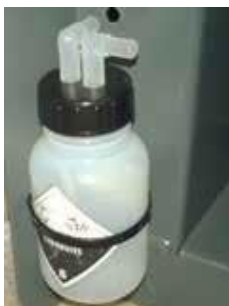
Obrázek 7: Odlučovač kondenzátu připevněný k nosiči
