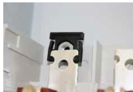
Obrázek 2: Připevnění matice pod plochý konektor
